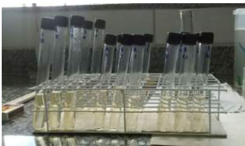
Figura 8. Resultado do teste presuntivo do método de tubos múltiplos
